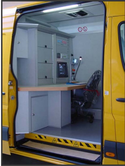
Cockpit: Steuerung, Monitor, Dateneinblendung DVD Rekorder, Monitor für Rückraumkamera
