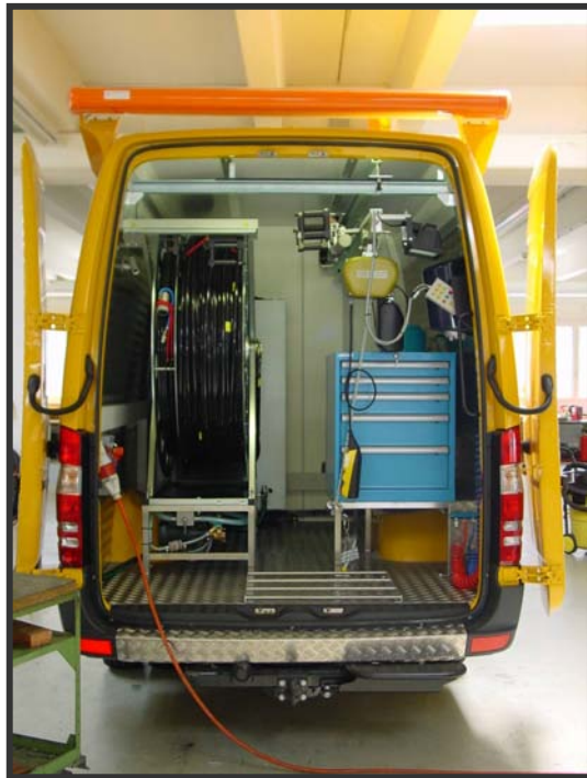
Aggregaterraum: Kabeltrommel, Hydraulik- anlage, Wassersystem, Kran, Werkzeugschrank
