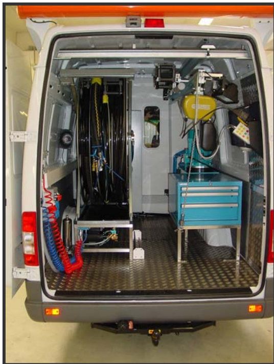
Aggregaterraum: Kabeltrommel, Hydraulik- anlage, Wassersystem, Kran, Werkzeugschrank
